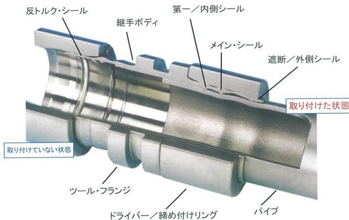
取り付けの際、継手ボディ上にあるLOKRING™のドライバーの軸方向の動きにより、ボディがパイプ表面に締め付けられ、パイプの肉厚が最初は弾性的に、続いて塑性的に圧縮されます。パイプの肉厚に締め付け作用に対する抵抗が生じるため、継手ボディ内の狭いシール部とパイプ表面との接触部に大きな圧縮荷重が発生します。
